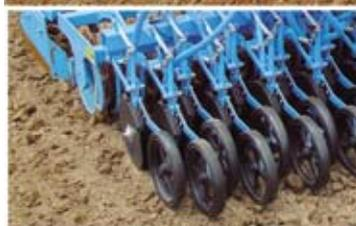
Двухдисковые сошники с резиновыми роликами обеспечивают точную глубину посева
