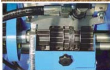
Отличное дозирование семенного материала, благодаря электрическому приводу вала высевающего аппарата
