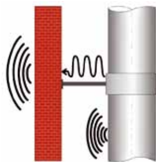
Рис. 2. Схема передачи звуковых волн при работе системы внутренней канализации
