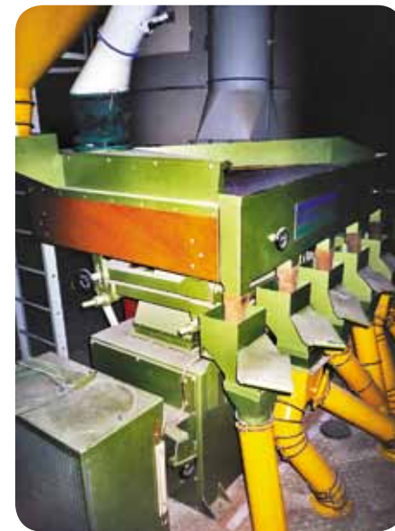
Рисунок 1. Пневмосортировальный стол KA-1200 фирмы Westrup на семяочистительной линии семенного завода в Версале (Франция)
