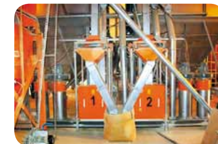
Фото 4. Смесительная установка с двумя дробилками молоткового типа на свиноводческом «Сувар-2» в Чувашии
