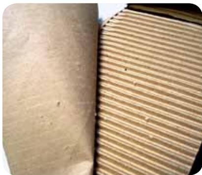
**Фото 5.** Расслаивание слоев гофрокартона по кромке более установленного допуска
