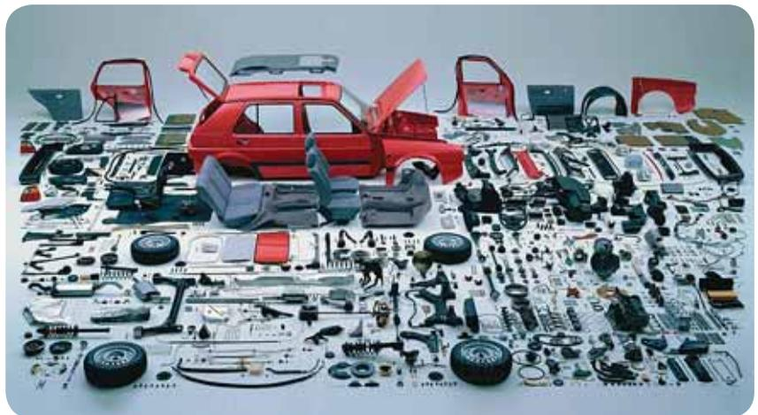
**Фото.** Узлы и детали легковой автомашины
