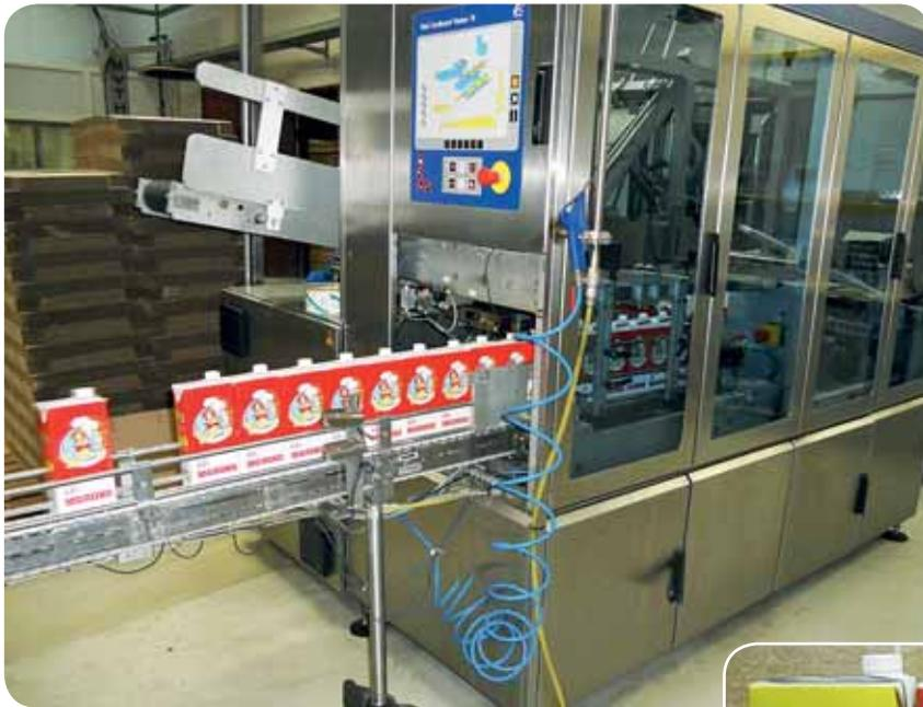
**Фото 2.** Упаковка молока Tetra Brik Aseptic с системой открывания HeliCap™ 23
