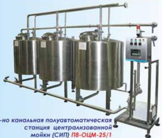
1-но канальная полуавтоматическая станция централизованной мойки (СИП) П8-ОЦМ-25/1
