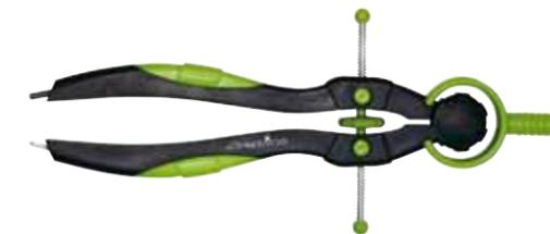
Циркуль-измеритель (или разметочный циркуль) служит для измерения и для откладывания на плане отрезков прямых линий, а также для деления отрезков и дуг окружностей на равные части, также его используют для сравнения наружных линейных размеров деталей с размерами, взятыми по масштабной линейке. Концы ножек снабжены винтами, которые закрепляют сменные иглы.
